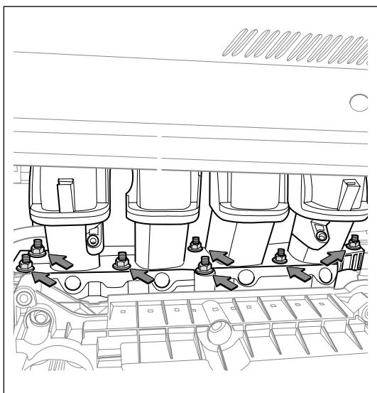
(o). 拆卸进气歧管固定螺母, 取出进气歧管。
